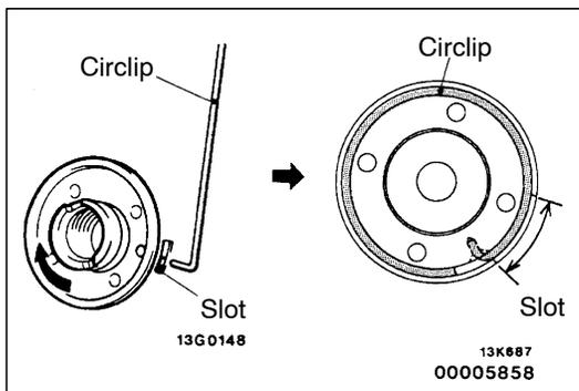
►E◄ CIRCLIP INSTALLATION
