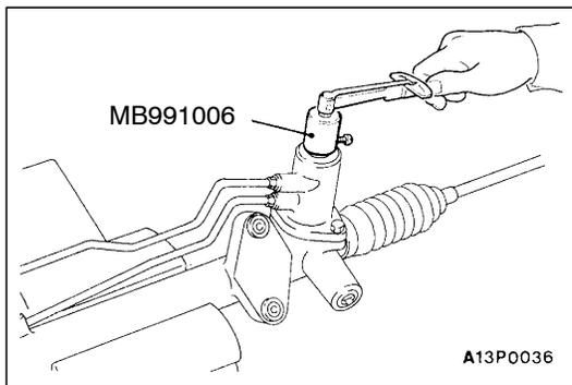
**INSPECTION****GEAR BOX PINION TOTAL ROTATION TORQUE CHECK****Caution**
